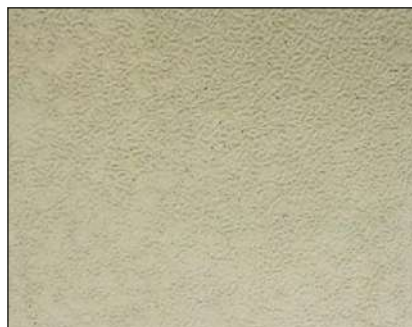
• Рисунок А.23 – Коррозия металла: балл K2
