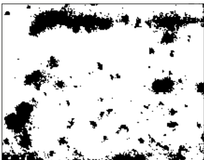
Рисунок А.24 – Коррозия металла: балл K4
