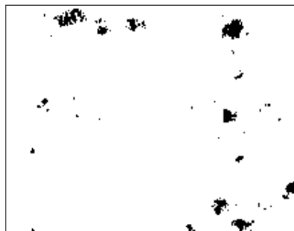
• Рисунок А.23 – Коррозия металла: балл K2
