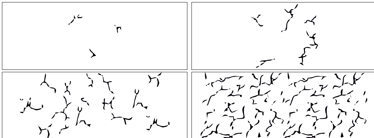
• Рисунок А.9 – Усадочная деформация
